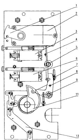
1、一种断路器用弹簧操作机构，包括框架、储能电机、储能传动系统、合闸机构、分闸机构，储能传动系统包括齿轮副及链轮副，储能电机与行程开关相连，其特征在于：所述储能电机（2）通过齿轮副（16）及链轮副（17）与储能轴（12）相连，储能轴（12）与储能弹簧（15）相连，链轮副（17）通过键联结套在钢套（18）的外表面上，钢套（18）与滚柱（19）相连；储能轴（12）与凸轮（11）相连；所述合闸机构包括合闸电磁铁（6）、合闸挚子（8），合闸电磁铁（6）设在合闸挚子（8）的侧端，合闸挚子（8）转动安装在支撑轴（9）上；合闸挚子（8）与凸轮（11）相连；所述分闸机构包括分闸电磁铁（3）、脱扣板（4），分闸电磁铁（3）设在脱扣板（4）的侧端，脱扣板（4）与半轴（5）相连；合闸保持挚子（10）转动安装在支撑轴（9）上，合闸保持挚子（10）与半轴（5）相连；半轴（5）、支撑轴（9）以及储能传动系统由左侧板（21）和右侧板（25）来支撑，分闸电磁铁（3）、合闸电磁铁（6）和储能电机（2）固定在右侧板（25）上，左侧板（21）和右侧板（25）通过轴（20）连接成框架。
