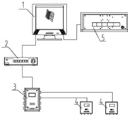
1. 一种采煤工作面推进度监测装置,其特征在于:它包括:装有KMJ30采动应力监测系统软件的主机、地面传输接口、至少一个矿压通讯分站和至少一个综采支架压力记录仪;该主机通过电缆与该地面传输接口相连接,该地面传输接口通过电缆与该矿压通讯分站相连,该矿压通讯分站与该综采支架压力记录仪之间通过电缆连接。
