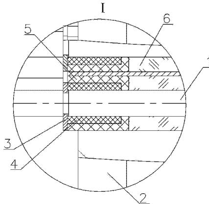
1. 一种水下抗压密封连接器,包括壳体,壳体的内孔中通过烧结玻璃饼固定有一个以上的接触件,其特征在于:所述烧结玻璃饼朝向接触件与适配接触件插接的插接端的端面上密封贴设有密封垫,密封垫的外周与壳体的内孔孔壁密封配合,各个接触件密封穿设在密封垫上设置的穿设孔中并由穿设孔中穿出。
