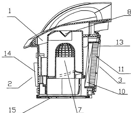
1、一种吸尘器旋风集尘装置，包括尘杯，所述尘杯前端设置有进风口，尘杯后端设置有出风口，其特征在于：所述尘杯内设置有旋风腔、第一集尘腔和第二集尘腔，所述进风口和旋风腔相连通，所述旋风腔内设置有一个导风件，所述导风件底部设置螺旋面，所述导风件上部罩有一通风网罩，所述旋风腔顶部设置有一个集尘口，所述旋风腔通过集尘口和第一集尘腔相连通，导风件内为空腔，所述导风件内的空腔和第二集尘腔相连通，所述第二集尘腔出口安装有过滤介质并和出风口相连通。
