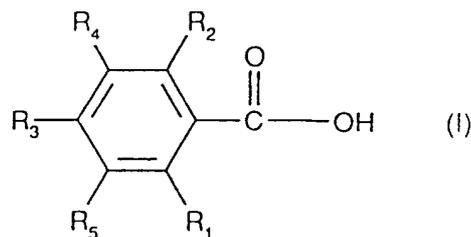
该法包括在最高压力为 10 巴和 -20 至 +40°C 温度范围内进行羧化反应, 在预分离化学式 I 的羧酸后或不预分离化学式 I 的羧酸条件下进行卤化。
