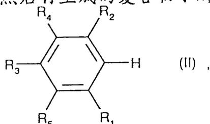
式中  $R_1$ 、 $R_2$ 、 $R_3$ 、 $R_4$  和  $R_5$  有上述相同的含义，该法包括在最高压力为 10 巴和温度在  $-20$  至  $+40^\circ\text{C}$  范围内进行羧化反应。
