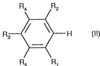
式中  $R_1$ 、 $R_2$ 、 $R_3$ 、 $R_4$  和  $R_5$  有上面给出的含义,该法包括在最高压力为 10 巴,温度在  $-20\sim+40^\circ\text{C}$  范围内进行羧化反应。
