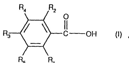
该法包括在最高压力为 10 巴和温度在  $-20 \sim +40^{\circ}\text{C}$  范围内进行羧化反应, 预分离化学式 I 的羧酸后或不预分离化学式 I 的羧酸就进行卤化。
