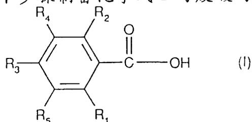
式中  $R_1$ 、 $R_2$ 、 $R_3$ 、 $R_4$  和  $R_5$  各自独立为氢、 $C_1$ — $C_{20}$  烷基、卤素和  $C_5$ — $C_8$  环烷基，条件是取代基  $R_1$ 、 $R_2$ 、 $R_3$ 、 $R_4$  和  $R_5$  中至少两个是烷基和/或环烷基；化学式 II 的芳烃在弗瑞德—克来福特催化剂存在下与二氧化碳反应，然后将生成的复合物水解生成相应的羧酸，
