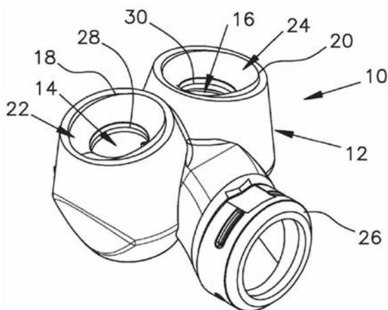
1. 一种喷雾喷嘴,其具有喷嘴外壳(12)、布置在所述喷嘴外壳(12)中的至少一个涡流室(14、16)、以及至少一个出射开口(18、20),其中,所述出射开口(18、20)布置在出射管(22、24)的端部处,所述出射管(22、24)起源于所述涡流室(14、16)并且沿朝向所述出射开口(18、20)的方向扩宽,其中,收缩部布置在从所述涡流室(14、16)到所述出射管(22、24)的过渡部处,并且其中,所述出射管的壁的角度从所述收缩部开始沿朝向所述出射开口(18、20)的方向稳定地增加或部分地沿朝向所述出射开口(18、20)的方向稳定地增加且其余部分保持相同,其特征在于,所述出射开口(18、20)的形状偏离环形形状,并且在于当沿所述出射开口(18、20)的周向方向观察时,所述出射开口(18、20)处的所述出射管(22、24)的壁的角度不恒定,待喷涂液体经由单个液体入口以切向方式被供应到所述涡流室中的每个,所述至少一个涡流室除所述液体入口和所述出射开口之外的部分被完全封闭。
