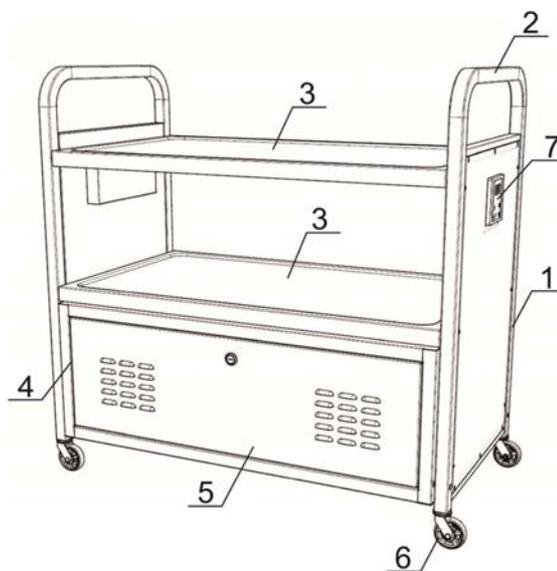
1. 一种移动电源式推车,其特征在於:包括车架,车架底部安装轮子,且在轮子的作用下整个车架保持平稳;车架上设置电池柜,该电池柜设置前柜门,并在内部设置若干电池仓,且在电池仓内设置放电插头;在电池柜内设置逆变器,所有电池包通过放电线路并联后连接逆变器,并在车架上设置插座,用于连接用电设备;该移动电源式推车还设置开关,用于控制放电线路的通断。
