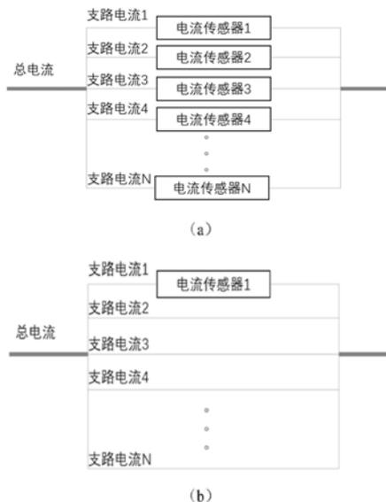
1. 一种用于电机控制系统中的电流测量装置,所述电机为单相、三相或多相绕组电机,每相绕组包括N路并绕组,其特征在于:所述电流测量装置包括对应于电机每相绕组的n个电流传感器, $1 \leq n < N/2$ ,其中单个电流传感器用于测量N路并绕组中的任一支路电流;所述电流测量装置还包括信号处理模块,所述信号处理模块用于接收所述电流传感器检测的电流信号  $\{I_1, I_2, \dots, I_n\}$ ,并计算得到每相绕组的电流  $I_R = \beta N (I_1 + I_2 + \dots + I_n) / n$ ,其中 $\beta$ 为修正系数,以及电机总电流。
