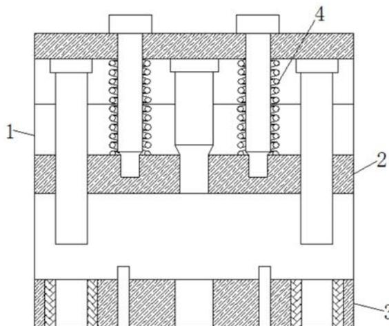
1. 一种基于电致发光原理的热塑性塑料成型设备,包括支撑架(1),其特征在于:所述支撑架(1)的内部活动连接有挤压板(2),挤压板(2)的下部活动连接有底板(3),挤压板(2)的上部通过弹簧(4)与支撑架(1)的内部顶壁活动连接,挤压板(2)的内部固定连接有机光机构(5),底板(3)的表面开设有注塑通道(6)。
