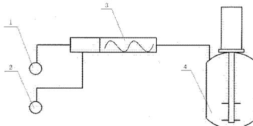
1. 聚氨酯预聚体乳化系统,其特征在于:所述系统包括一工艺水泵(1)和一低聚物泵(2),工艺水泵(1)和低聚物泵(2)的出液端均与静态混合器(3)的进液端连接,静态混合器(3)内设有混合腔,该静态混合器(3)的出液端与乳化釜(4)的进液端连接,该低聚物泵(2)的输送扬程为0.2MPa-0.4MPa,工艺水泵(1)的输送扬程为0.2MPa-0.4MPa。
