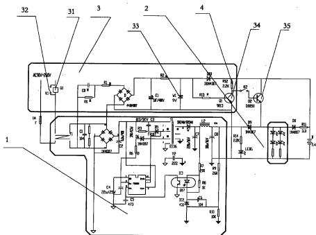
1、一种 LED 照明应急灯的电路，其特征在于：所述 LED 照明应急灯的电路由开关电源电路（1）、光源电路（2）、普通照明和应急照明切换电路、待机无功耗电路、电池充电放电保护电路及停电识别电路（3）六部分连接构成，所述停电识别电路（3），包括有高阻抗元件（31），所述高阻抗元件（31）与并联在开关一（32）上，所述停电识别电路（3）通过所述高阻抗元件（31）与所述开关电源电路（1）电路连接；所述停电识别电路（3）还包括有一共用电阻（4），所述光源电路（2）电路连接所述共用电阻（4）后与所述停电识别电路（1）电路连接。
