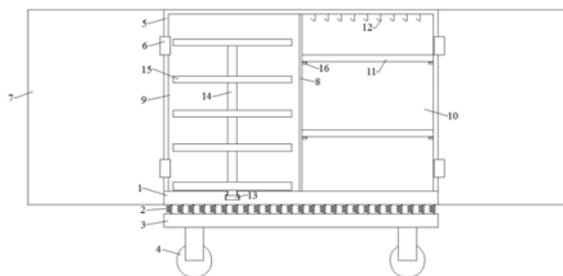
1. 一种国际贸易用货品展示柜,其特征在于,包括固定板(1),所述固定板(1)的下表面竖向固定设置有弹簧组件(2),所述弹簧组件(2)的下端水平固定设置有底板(3),所述底板(3)的下表面设置能够自锁的车轮(4);
