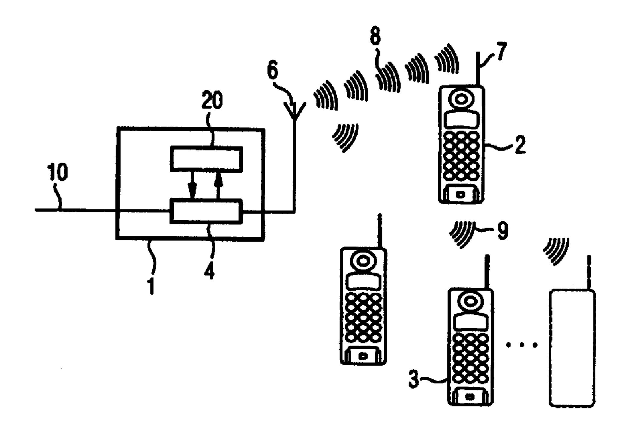
(57) La présente invention offre la possibilité de signaler numériquement une fréquence porteuse qui est utilisée à un moment prédéterminé après la signalisation. L'invention est mise en oeuvre en particulier selon ce que l'on appelle un mode multitrame d'une partie mobile (2) d'un système de transmission numérique, mode selon lequel la station mobile (2) ne reçoit des données en provenance d'une station fixe (1) que
