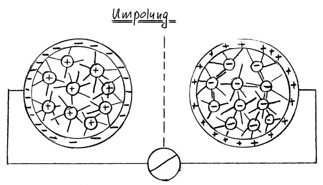
Umpolung bis zu einer Grenzspannung bei der noch heine Ladung zu den Fulleren zurückfließt. Porenwand und Fullerene sind zeht ungleichnamig geladen und bilden zwischen den Ladungen elektrische Felder.
