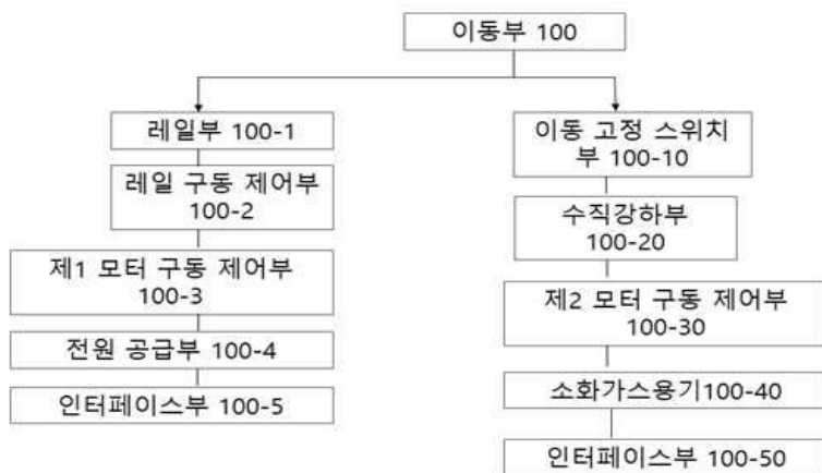
도 2. 화재 영상 감지를 위한 지능형 감지 시스템의 이동부 구성도
