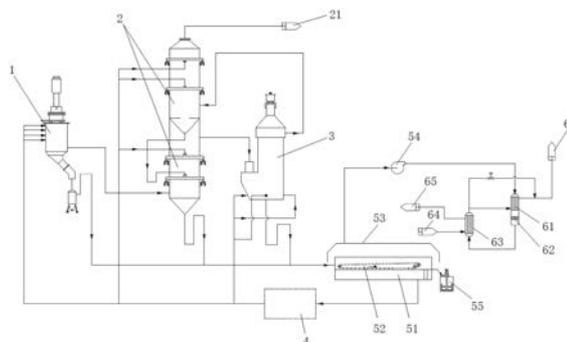
1. 一种炭黑水废气治理系统,其特征在於:包括依次连接的环保风罩、环保风机、催化转化预热器、催化转化器和蒸汽发生器;所述环保风罩、环保风机用于收集、输送炭黑水解析出来的解析气;所述催化转化器为用于将来自环保风机的解析气催化转化为二氧化碳和水;所述催化转化预热器包括管程和壳程,管程内为待加热气体,壳程内为加热介质;所述加热介质为由所述催化转化器导出,且经所述蒸汽发生器回收余热后的催化转化产物。
