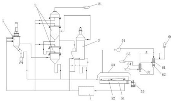
1. 一种炭黑水废气治理系统,其特征在于:包括依次连接的环保风罩、环保风机、催化转化预热器、催化转化器和蒸汽发生器;所述环保风罩、环保风机用于收集、输送炭黑水解析出来的解析气;所述催化转化器为用于将来自环保风机的解析气催化转化为二氧化碳和水;所述催化转化预热器包括管程和壳程,管程内为待加热气体,壳程内为加热介质;所述加热介质为由所述催化转化器导出,且经所述蒸汽发生器回收余热后的催化转化产物。
