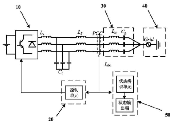
1. 一种基于电量频谱的电网状态辨识方法，应用该方法的系统包括逆变器主电路(10)，控制单元(20)，三相线路阻抗(30)，交流侧电网(40)和电网状态辨识单元(50)；所述逆变器主电路(10)包括依次串联的直流电源、三相全桥逆变电路和三相LCL滤波器，所述三相线路阻抗(30)包括三相线路电感和三相线路电容，所述交流侧电网(40)包括三相电网和接地模块，所述电网状态辨识单元(50)包括状态辨识单元和状态输出端；所述逆变器主电路(10)的输出端与三相线路阻抗(30)的一端相连，其连接点为公共耦合点PCC，三相线路阻抗(30)的另一端接入三相电网，三相电网的另一侧与接地模块相连；所述控制单元(20)的输入端与公共耦合点PCC相连、输出端与逆变器主电路(10)中的三相全桥逆变电路相连，所述电网状态辨识单元(50)的输入端与公共耦合点PCC相连、输出端与状态输出端相连；
