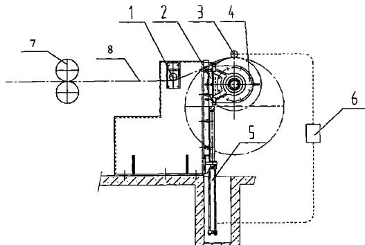
1. 控制异型金属带带型的卷取装置,其特征在于,该装置包括反弯辊、滑轨、光电传感器、卷取电机、液压缸、信号处理系统,所述的反弯辊设置在轧机和卷筒间,带材被轧机轧制成所需形状后,通过反弯辊向上弯曲卷取在卷筒上,卷筒通过卷取电机驱动旋转卷取带材,所述的卷取电机设置在滑轨上,所述的液压缸设置在卷取电机下方,所述的信号处理系统一端连接液压缸,另一端连接卷筒上方的光电传感器,卷筒开始卷取带材时,光电传感器处在最高位置,随着卷径的增大光电传感器逐渐下移,同时随着卷径的增大,当遮挡住光电传感器的光线时发信号传给信号处理系统,信号处理系统把光电传感器的信号经处理、放大,指令液压缸工作,驱动卷取电机沿滑轨进行升降,从而使带材与反弯辊之间形成合适的角度;所述的反弯辊与卷取电机通过程序控制器进行统一程序控制,随着卷筒卷径的增大,当遮挡住光电传感器的光线时,信号处理系统发出指令使液压缸动作卷筒下降,同时光电传感器通过程序控制器控制其位置随着卷径的增大逐渐下调,以控制带材反向弯曲的量。
