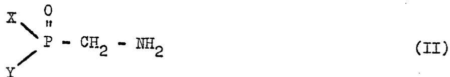
in der X und Y gleich oder verschieden sind und ein Alkyl-, Aryl-, Alkoxy-, Aryloxy-, Dialkylamino- oder Diarylamino-radikal darstellen, so daß die Organo-Phosphorverbindung z. B. ein Phosphonat, ein Phosphinat, ein Phosphinoxid oder ein Phosphonamid sein kann, mit einer Carbonylverbindung der Formel III
