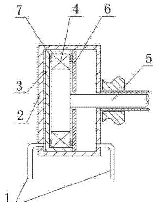
1. 离心机推料杆驱动装置，包括离心机机架、油缸(2)、设置在油缸(2)内的油活塞(3)、固定连接在油缸(2)上的油管(1)和一端位于油缸(2)中的推料杆(5)，其特征在于，所述油缸(2)固定连接在离心机机架上，还包括轴承(4)，所述油活塞(3)靠近推料杆(5)的一侧设置有轴承槽，所述轴承(4)位于轴承槽内，且轴承(4)的外圈与轴承槽呈过盈配合，所述推料杆(5)位于油缸(2)中的一端固定连接在轴承(4)的内圈上。
