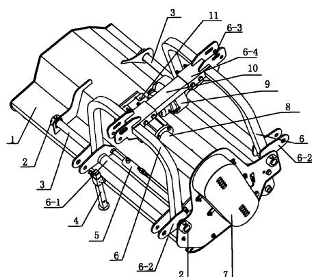
1、一种割灌机的悬挂机构，其特征在于：包括横置在机架或机罩（1）前后两侧平行的导轨（3）、两个悬挂架（6）以及油缸（5）或气缸，两个悬挂架（6）的下部及上部分别具有下悬挂连接板（6-2）和上悬挂连接板（6-3），且两个悬挂架（6）安装在两导轨（3）上并能横向移动，至少一个油缸（5）或气缸的一端安装在机架或机罩（1）上，另一端安装在悬挂架（6）的下部。
