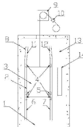
1. 一种防冲顶电梯的制动装置,该制动装置包括用于设置在升降通道(1)内通过导靴(4)使轿厢(3)升降的第一导轨(2),所述第一导轨(2)包括平行设置的第一轨道(6)和第二轨道(7);其特征在于:所述制动装置还包括第二导轨(8);所述第二导轨(8)包括用于使轿厢(3)停止运行设置在升降通道(1)顶端分别与第一轨道(6)和第二轨道(7)固定延伸连接的第三轨道(11)和第四轨道(12),所述第三轨道(11)和第四轨道(12)分别与竖直方向有夹角成正八字形设置。
