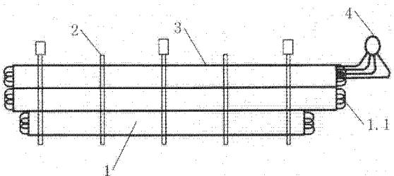
1. 一种锅炉低温省煤器，其特征是：在翅片管（1.2）上环绕有翅片（1.3），翅片管固定安装在竖支架（2）和横支架（3）之间，形成翅片管组（1），翅片管组通过翅片管连接管（1.1）相互连接，翅片管组一端与连管箱（4）连接；
