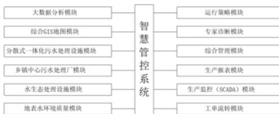
1. 一种基于大数据分析策略的区域水环境智慧管控系统,其特征在于,包括:大数据分析模块、综合GIS地图模块、分散式一体化污水处理设施模块、乡镇中心污水处理厂模块、水生态处理设施模块、地表水环境质量模块、运行策略模块、专家诊断模块、综合管理模块、生产报表模块、生产监控模块、工单流转模块;
