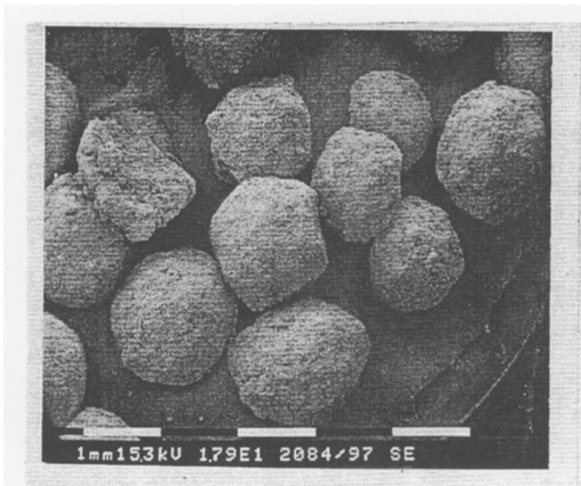
좁은 DOD를 갖는 다공성 폴리우레탄 입자의 SEM 사진, 배율 18x (실시예 1)
