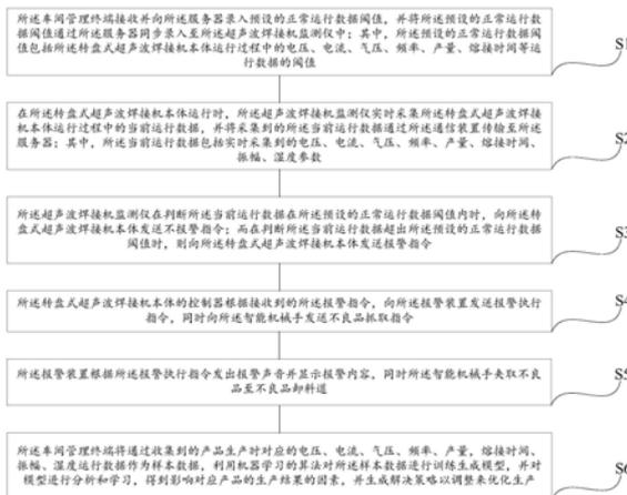
1. 一种基于转盘式超声波焊接机的生产管理方法,其特征在于,所述转盘式超声波焊接机包括转盘式超声波焊接机本体、超声波焊接机监测仪、通信装置、服务器、车间管理终端、智能机械手以及报警装置;所述超声波焊接机监测仪、所述智能机械手均安装在所述转盘式超声波焊接机本体上;
