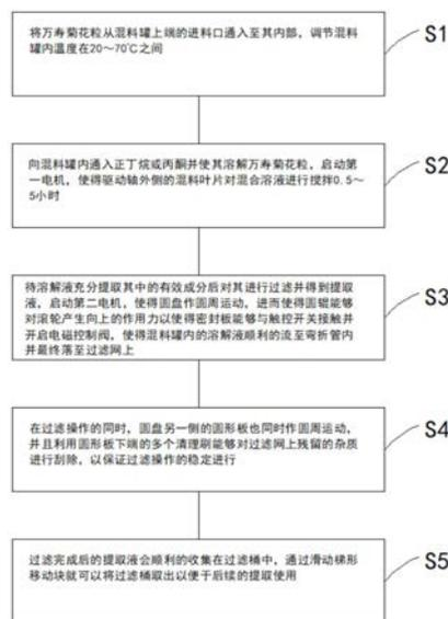
1. 一种叶黄素酯提取工艺,其使用了一种叶黄素酯提取装置,该叶黄素酯提取装置包括工作台(1)、混料机构(2)和过滤机构(3),其特征在于,采用上述叶黄素酯提取装置在对叶黄素酯进行提取时的具体工艺如下:
