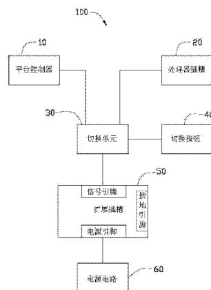
1. 一种主板，包括一处理器插槽、一平台控制器、一切换按钮、一切换单元、一扩展插槽及一电源电路，所述扩展插槽的信号引脚通过所述切换单元与所述处理器插槽或所述平台控制器连接，所述切换按钮与所述切换单元连接，所述扩展插槽的电源引脚与所述电源电路连接以从所述电源电路接收电压，所述切换按钮输出切换信号给所述切换单元，所述切换单元根据从所述切换按钮接收到的切换信号控制所述扩展插槽与所述处理器插槽或所述平台控制器连接，当所述扩展插槽与所述平台控制器连接时，由所述平台控制器提供总线信号给连接在所述扩展插槽上的固态硬盘，以使得所述主板与固态硬盘进行通信，当所述扩展插槽与所述处理器插槽上插接的处理器连接时，由所述处理器插槽所连接的处理器提供总线信号给连接在所述扩展插槽上的扩展卡，以使得所述主板与扩展卡进行通信。
