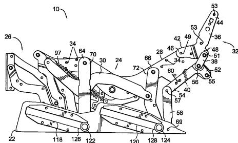
1. 一种用于运动家具的连杆系机构，包括：基板；脚踏板连杆系；耦合到脚踏板连杆系的座垫支撑连杆；可旋转地耦合到座垫支撑连杆并且可滑动可旋转地耦合到基板的前和后枢转连杆；可滑动可旋转地耦合到前枢转连杆的中间部分并且可旋转地耦合到后枢转连杆中间部分的长椅驱动连杆；耦合在长椅驱动连杆和脚踏板连杆系之间的主长椅连杆，该主长椅连杆可旋转地耦合到座垫支撑连杆，其中主长椅连杆和长椅驱动连杆协作，从而在闭合位置和打开位置之间移动脚踏板连杆；以及靠背连杆系将座垫支撑连杆耦合到基板。
