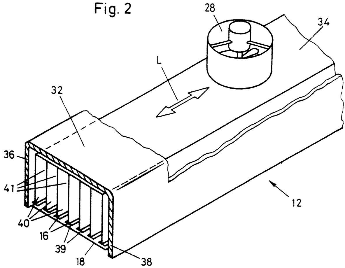
Die vorliegende Patentanmeldung bezieht sich auf ein Verfahren und eine Vorrichtung zum Bilden, Hochhalten und Spannen einer Schlaufe um das Packgut einer Banderoliermaschine, welche eine die Ausdehnung der Schlaufe begrenzende Bandführung mit einer Gleitfläche umfasst.
