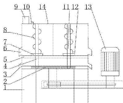
1. 一种水力碎浆机，包括箱体(14)、转子、筛板(5)和支架(1)，所述箱体(14)设置在支架(1)的上端，箱体(14)内部的下段设置有筛板(5)，所述的箱体(14)顶端设置有进料口(9)和喷水口(10)，所述箱体(14)两边均设置有出渣口(6)和出浆口(3)，所述出渣口(6)位于筛板(5)上方，所述出浆口(3)位于筛板(5)下方，其特征在于，所述转子包括第一转子(7)和第二转子(12)，所述箱体(14)内部设置有第一内腔和第二内腔，所述第一内腔中间位置设置有第一转轴(4)，所述第一转轴(4)套设有第一转子(7)，所述第二内腔中间位置设置有第二转轴(11)，所述第二转轴(11)套设有第二转子(12)，所述第一转轴(4)和第二转轴(11)下方连接有过桥齿轮(2)，所述的过桥齿轮(2)下方连接有轴承齿轮。
