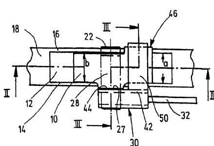
1. 一种用来将一刮水片的主弓形架（18）与一刮水装置的刮水杆（32）的连接段（30）相适配的转接器（10，100），具有：
