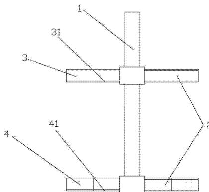
1. 一种缩合反应釜的搅拌器,包括转轴(1)以及与所述转轴(1)固定连接的桨叶(2),其特征在于:所述桨叶(2)包括位于转轴中部的至少两片上桨叶(3)和位于转轴底部的至少两片下桨叶(4),所述上桨叶(3)设有相对水平方向倾斜的下压片,所述下桨叶(4)设有相对水平方向倾斜的上压片。
