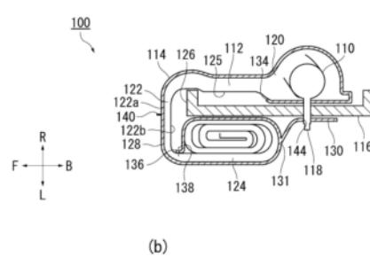
1. 一种侧安全气囊装置，具备安全气囊模块，该安全气囊模块安装在车辆用座椅内部框架中沿座椅靠背侧面的框架侧板部，其特征在于，
