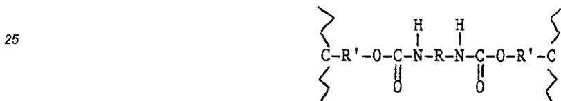
30 dans laquelle R est un rest aliphatique, cycloaliphatique ou aromatique, R' un reste aliphatique ou cycloaliphatique comportant au moins une liaison CO et/ou CN permettant de le relier à la chaîne polymère tel que un reste d'acrylate ou méthacrylate d'alkyle (alkyle = éthyle, propyle, butyle) ou un reste aminoalkyle [alkyle = di-(éthyle), di(propyle), di(butyle)] ou R' est nul
