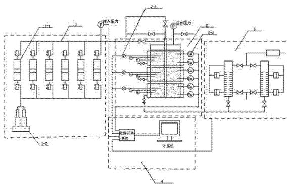
1. 径向流驱替物理模型系统,其特征在于它由注入系统(1)、三维径向流物理模型(2)、油气水三相计量系统(3)和数据采集系统(4)组成,注入系统(1)与三维径向流物理模型(2)相连,三维径向流物理模型(2)与油气水三相计量系统(3)相连,径向流物理模型(2)与油气水三相计量系统(3)分别与数据采集系统(4)相连。
