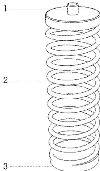
1. 弹簧电池，其特征在于包括弹簧电池功能器，所述功能器上设有电池正极、弹簧连接电线、电池负极，所述电池正极与弹簧连接电线连接，所述弹簧连接电线与电池负极连接。
