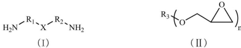
所述式(I)的二胺类化合物和所述式(II)的缩水甘油醚类化合物选自以下组合中的一种:间苯二甲胺与丁基缩水甘油醚、间苯二甲胺与烯丙基缩水甘油醚、间苯二甲胺与1,6-己二醇二缩水甘油醚、间苯二甲胺与三羟甲基丙烷三缩水甘油醚、间苯二甲胺与季戊四醇四缩水甘油醚、二乙烯三胺与1,4-丁二醇二缩水甘油醚、二乙烯三胺与新戊二醇二缩水甘油醚、二乙烯三胺与1,6-己二醇二缩水甘油醚、二乙烯三胺与丙三醇三缩水甘油醚、二乙烯三胺与三羟甲基丙烷三缩水甘油醚、三甲基二胺与1,6-己二醇二缩水甘油醚、三甲基二胺与三羟甲基丙烷三缩水甘油醚、1,3-环己二甲胺与1,6-己二醇二缩水甘油醚、1,6-己二胺与1,6-己二醇二缩水甘油醚;
