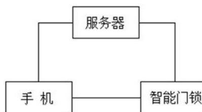
1. 一种基于物联网的校园指纹智能门锁系统,其特征是包括系统服务器、智能门锁,所述智能门锁与所述系统服务器通信连接,所述智能门锁包括门锁控制模块、锁芯机构、门锁动力装置、门锁远程通信模块、人机交互模块;
