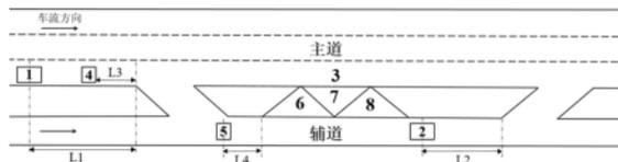
1. 一种可切换方向的城市快速路平面匝道控制系统,其特征在于,包括设置于主道最外侧车道且距离出口匝道长度为L1的第一车辆检测器(1)、设置于辅道且距离入口匝道长度为L2的第二车辆检测器(2)、特殊匝道(3)、第一显示器(4)和第二显示器(5);所述特殊匝道(3)位于相邻的出口匝道和入口匝道之间,第一显示器(4)设置在主道最外侧车道且距离出口匝道L3处,第二显示器(5)设置在辅道且距离特殊匝道(3)L4处;
