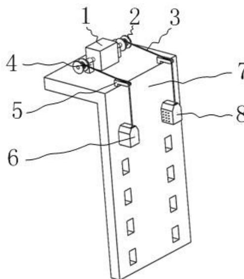
1. 一种基于钢绳的建筑高楼逃生机构,其特征在於:它包括电机驱动装置、第一缠绕轮、钢绳、第一支撑、第一导向机构、第一承载装置、第二承载装置、驱动轴,其中电机驱动装置安装在高楼的楼顶;两个驱动轴分别通过一个第一支撑安装在高楼的楼顶;两个驱动轴分别与电机驱动装置的两个输出轴连接;两个第一缠绕轮分别安装在两个驱动轴上;两个第一导向机构分别安装在高楼楼顶的两侧,且两个第一导向机构分别与两个第一缠绕轮配合;两股钢绳的一端分别缠绕在两个第一缠绕轮上;两股钢绳的另一端分别绕过两个第一导向机构位于墙壁的一侧;第一承载装置和第二承载装置分别与两股钢绳连接;墙壁上靠近第一承载装置和第二承载装置的一侧面上均匀地分布有多组贯通的逃生口;每组逃生口中的两个逃生口均分别与第一承载装置和第二承载装置配合;墙壁上所分布的逃生口与楼层相互配合;
