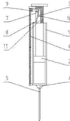
1. 一种带助力的麻醉注射器，包括注射器，注射器是由针管、活塞、推拉杆、针头座和针头组成，其特征在于设有回缩弹簧、定位杆、顶板、回缩按钮和铰轴，回缩弹簧设在针管侧面，回缩弹簧一端与针管固定连接，另一端与推拉杆固定连接，推拉杆后部一侧设有定位凹槽，定位凹槽内设有定位杆，定位杆经铰轴与推拉杆相铰接，定位杆一端与回缩按钮相铰接，另一端与顶板相连接，回缩按钮与推拉杆螺纹连接。
