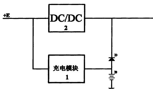
1. 一种直流电源与铅酸蓄电池并联供电方法，由铅酸蓄电池和向铅酸蓄电池提供充电电流的充电模块组成的供电支路，所述充电模块的一端连接至直流电源的正极，所述充电模块的另一端连接至铅酸蓄电池的负极，还包括由 DC-DC 模块组成的主供电支路，所述 DC-DC 模块的输入端也连接至直流电源的正极，所述 DC-DC 模块的输出端连接至负载，其特征在于：
