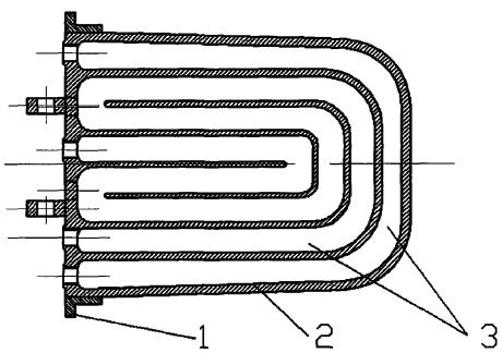
1、一种铜冷却板，包括一铜本体（2），其特征在于，铜本体（2）一端包裹有钢带或钢环（1），该铜本体（2）内设置内腔水道（3），内腔水道（3）截面的外缘为曲线形。
