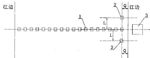
1、一种隧道过江施工中用于监测河床沉降的装置，其特征在于包括由至少二个沉入江底固定的水压传感装置组成的水压传感采集机构及设置于江边的信号接收处理分析装置（3），其中，所述信号接收处理分析装置（3）包括用于接收各水压传感装置产生的振动信号的信号接收仪及包含有数据处理及分析系统的电子处理装置，所述各水压传感装置分别通过数据线与信号接收仪相连接，所述信号接收仪通过数据线与电子处理装置相连接并通过电子处理装置对水压传感装置产生的信号进行实时处理分析而得到河床沉降的监测数据。
