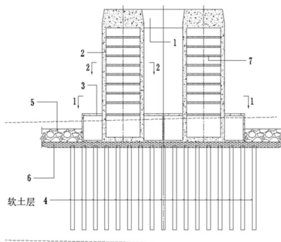
1. 一种适用于深水软土地地区的桥塔复合基础,其特征在于:所述桥塔复合基础包括:打入桩(4)、垫层(6)、防冲刷层(5)、预制沉箱(3)、塔柱;
