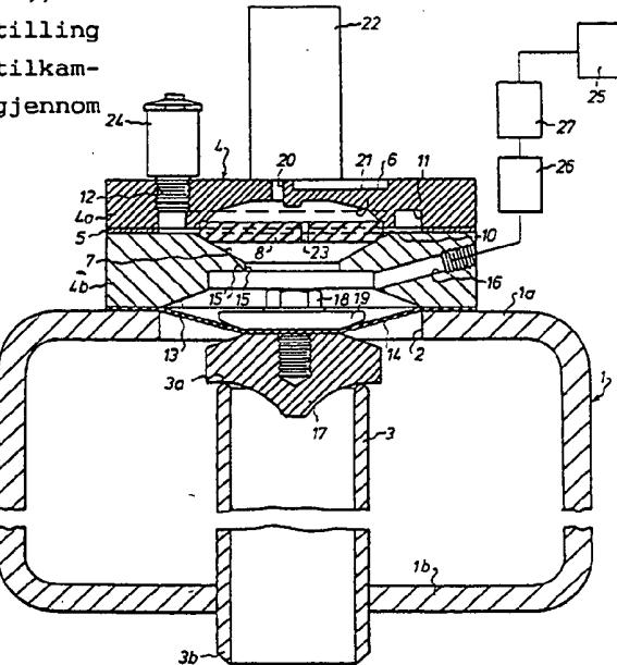
Oppfinnelsen angår en ventilanordning omfattende et ventilhus som har et ventilkammer med et utløp og et innløp som er innrettet til å forbindes med en trykkmediumkilde, og en
