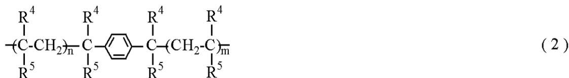
〔式中、 $\text{R}^4$ 、 $\text{R}^5$ は同一又は異種の非置換又は置換の一価炭化水素基、 $m$ 、 $n$ は正の整数（但し、(A)成分の数平均分子量が500～50,000となる数）である。〕
