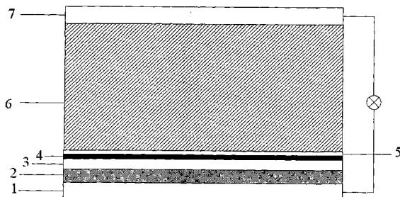
1. 一种染料敏化太阳能电池光阳极，包括沉积在透明导电玻璃上的二氧化钛纳米多孔薄膜和染料单分子层，其特征在于，所述染料单分子层上沉积纳米二氧化硅阻挡层，纳米二氧化硅阻挡层上吸附第二层染料单分子层，构成染料敏化太阳能电池光阳极。
