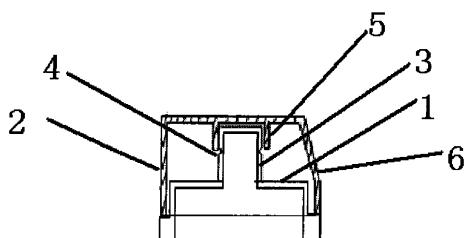
1、 组合式瓶盖，主要包括内盖(1)和外盖(2)，其特征在于：内盖(1)上设有一个与瓶内相通的向上的流液管(3)，该流液管(3)侧部开有一个易断凹痕(4)；所述外盖(2)顶部内侧设有一个向下的柱形管(5)，所述流液管(3)的上端部伸入该柱形管(5)内。
